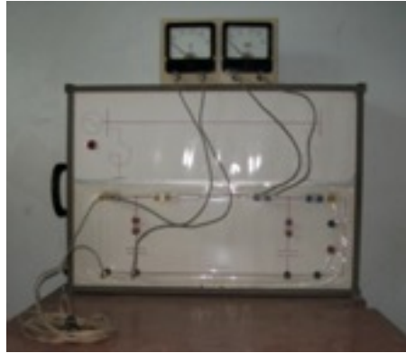
Figura 5: Modelo activo de la línea compacta a 220kV Juraguá Camagüey, con 325km diseñada en Cuba, pero no construida.
